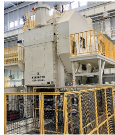
車のCVJ（等速ジョイント）製造ラインの鍛造用機械プレス（C2F・20GWL）（JTEKT 戸岬工場）
