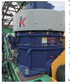
自動調節機能を搭載した「ブレイジコーククラッシャー」
