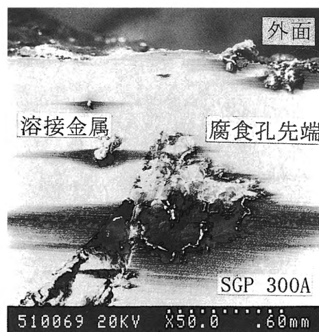
(a) 腐食孔先端部
