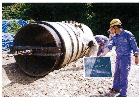
図15 牽引試験状況 (ゴムリングタイプ) Fig.15 Tractive test (Type rubber-ring)
