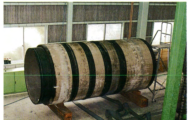
図9 供試推進管φ1800（ゴムリングタイプ） Fig.9 Externals of pipe φ1800 (Type rubber-ring)
