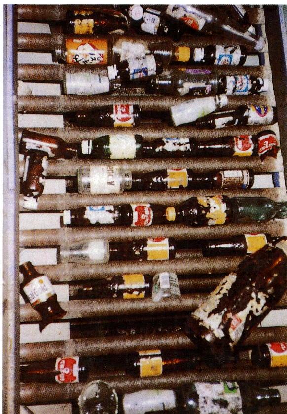
図6 ローラスクリーン上を流れるガラス瓶 Fig.6 Glass bottles on roller screen
