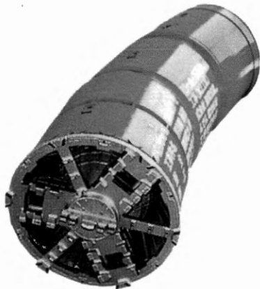
図4 セミシールド機 Fig. 4 Semi-sealed machine
