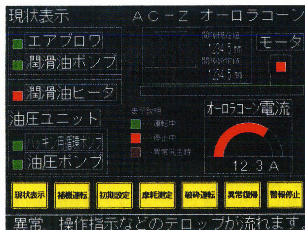
図10 制御盤表示の一例 Fig.10 Example of control panel display
