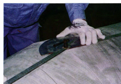
図9 中心線の合わせ目角度の測定
