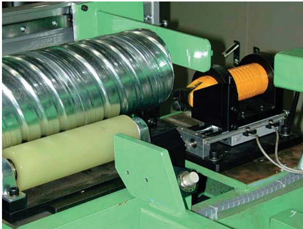
図11 ハゼ切りステーション Fig. 11 Station of lock seam cutting
