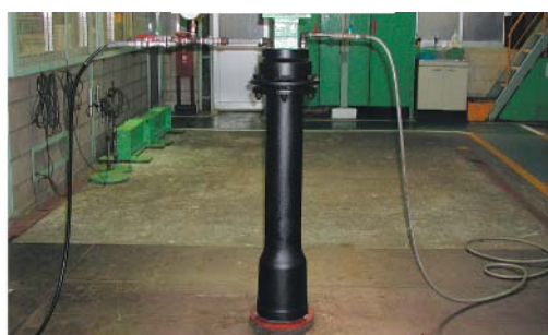
管体水圧試験
