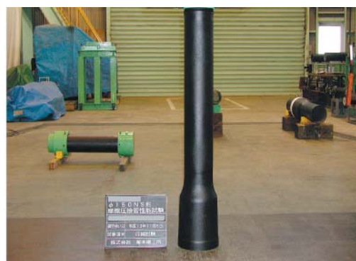
管体圧縮試験
