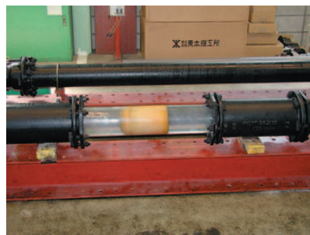
図9 ポリピグ通過試験状況
