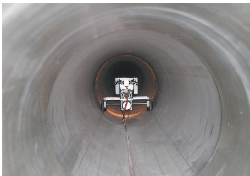
図20 管内カメラによる胴付間隔測定状況
