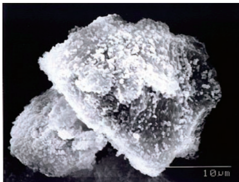
図7 酸化チタンが付着した粒子 Fig.7 Titanium oxide adhesion particle
