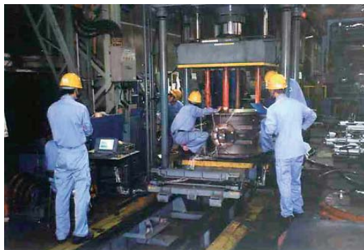
図5 水圧試験状況
