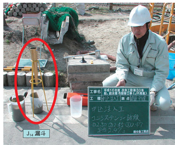
図21 コンシステンシー試験
