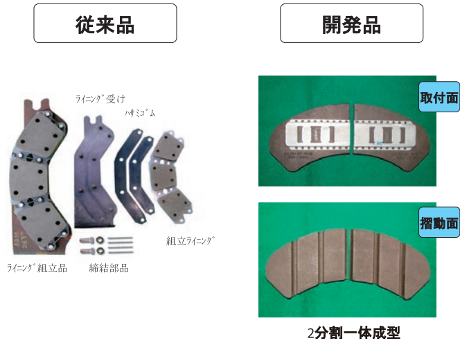
図3 ライニング構造の比較
