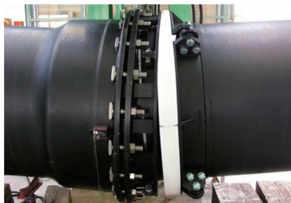
図24 φ900継手7°曲げ状況
