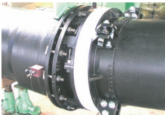
図23 φ500継手7°曲げ状況
