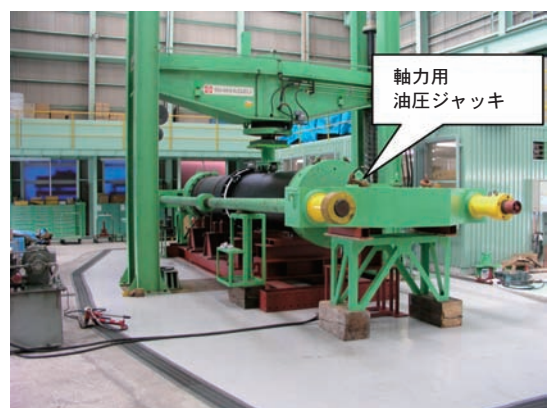
図11 φ900軸圧試験状況(継手曲げ)
