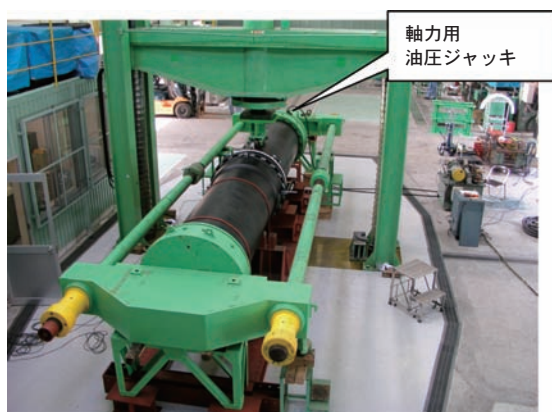
図9 φ500軸圧試験状況(継手曲げ)
