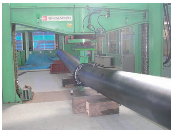
図18 φ500継手曲げ実験状況
