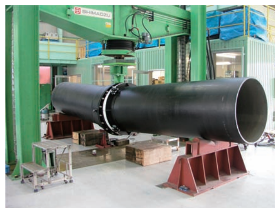
図19 φ900継手曲げ実験状況
