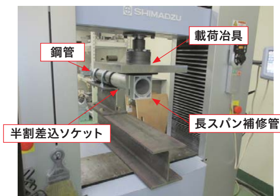
図8 半割差込ソケット曲げ試験
