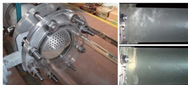
図5 キャビテーション目視試験（ \sigma \approx 0.3 ） （左：1Q型無水状態 右上：BV型、右下：1Q型）
