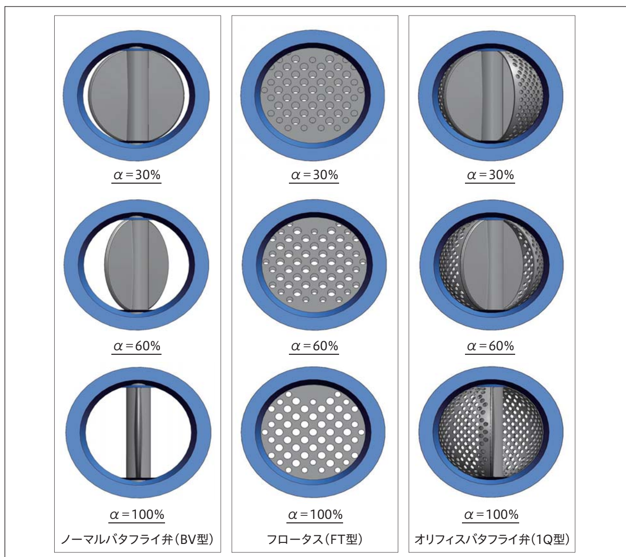
図3 開度 \alpha における流体通過面積
